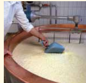
Die Käseharfe zerteilt die dickgelegte Milch.
